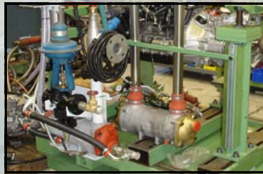
Enfriadores de Aire de Admisión en una instalación experimental de ensayos de motor.
