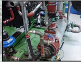
Gran Sistema de refrigeración montado en un banco de pruebas para motores.
