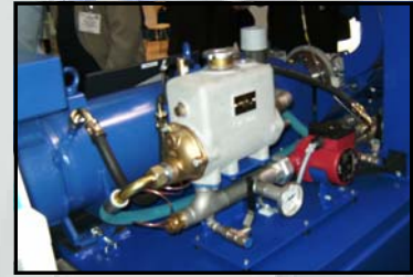
Un Pequeño Intercambiador de calor para Tanques de Compensación utilizado sobre una plataforma de ensayos de aceite.
